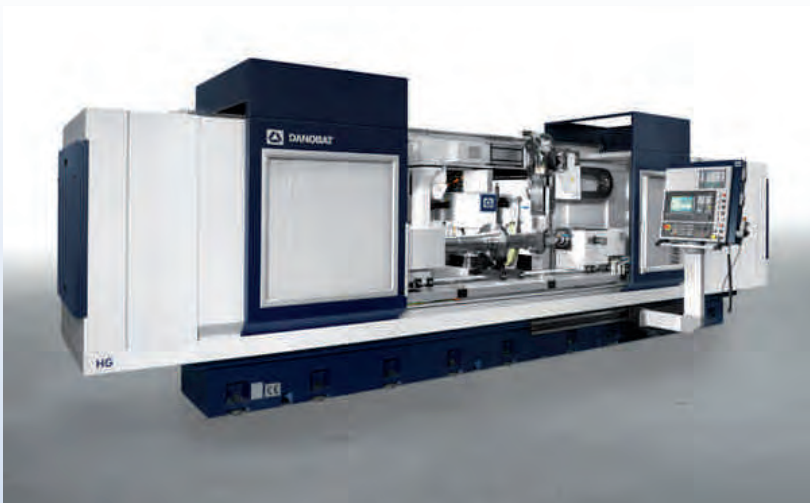
DANOBAT GROUP – Kanpoko artezteko makina zilindrikoa, gama ertainekoa eta astuna, mahai mugikorra duena. Transmisiorako, sorgailu elektrikoetarako, industria aeroespazialerako, trenetarako, inprimategietarako, laminaziorako, automoziorako, eta ibilgailu industrialetarako piezak egiteko erabiltzen da, baita ingeniari mekanikoko aplikazioen ardatzak egiteko ere.
